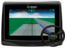
**Computadora de pulverización Smart Jan -JEP 2.000.** Mantiene constante el volumen de pulverización (L/ha), con variación en la velocidad del pulverizador o alteración en la rotación del motor diesel. Visualización y memorización de datos de trabajo, como por ejemplo: área tratada, dosis programada y dosificador aplicado.
