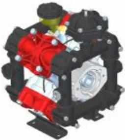
**Bomba** de pulverización de membrana 170 l/min, accionada por motor hidráulico. Grande salida y presión para los picos, garantizando óptima penetración del producto a aplicar. Flujo de líquido continuo, lubricada a aceite, altamente resistente a la acción corrosiva de los químicos.
